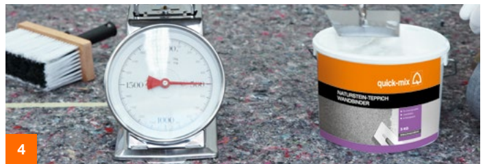
4 Für die Erstellung einer tragfähigen und verfestigten Oberfläche für quick-mix Naturstein-Teppich ca. 0,5 kg quick-mix Naturstein-Teppich Wandbinder mit einer Kelle in einen sauberen Eimer geben und als Grundierung verwenden. 0,5 kg quick-mix Naturstein-Teppich Wandbinder reichen als Grundierung für ca. 1,75 m 2 aus. Das Werkzeug anschließend sofort mit Wasser reinigen.
